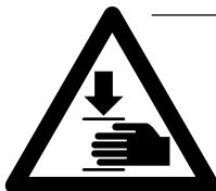
**Wegen Verletzungsgefahr ist das Hantieren zwischen dem Joch / Säulen während des Betriebes verboten !**
